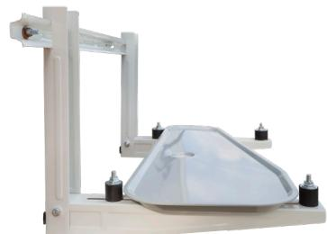
Bildet illustrerer plasseringen av dryppannen. Skru ikke fast de øver planbrikkene og mutterne på vibrasjonsdempene før pumpen er på plass.
